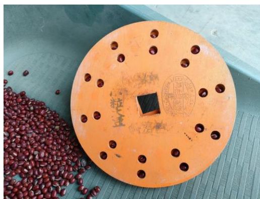
写真2 種子の大きさに合わせたは種板の選択
