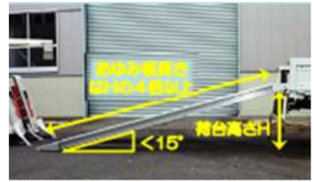
写真20 歩み板の設置事例（農研機構 農作業安全啓発用ポスターより）
